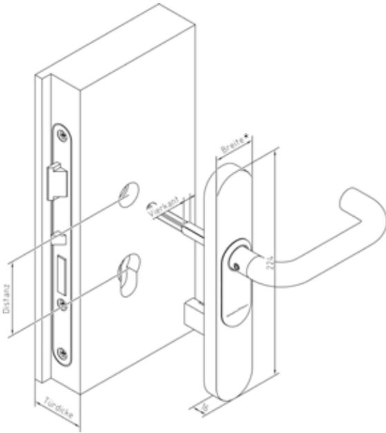
// **ABMESSUNGEN FÜR KONVENTIONELLE MONTAGE MIT MECHANISCHER ÜBERSCHLIEßUNG**
