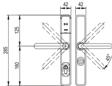
Ex7P6 (beidseitig Drücker, mechanische Notöffnung mit elektronischer Protokollierung über Halbzylinder außen, mechanischer Zylinder nicht enthalten, elektronische „Bitte nicht stören“-Funktion innen)
