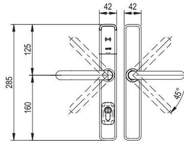
Ex7P0 (beidseitig Drücker, mechanische Notöffnung mit elektronischer Protokollierung über Halbzylinder außen, mechanischer Zylinder nicht enthalten)
