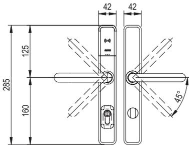
Ex7P1 (beidseitig Drücker, mechanische Notöffnung mit elektronischer Protokollierung über Halbzylinder außen, mechanischer Zylinder nicht enthalten, Drehknopf innen)
