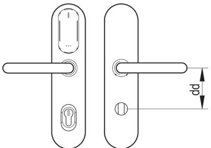
EM6P1 (beidseitig Drücker, mechanische Notöffnung mit elektronischer Protokollierung über Halbzylinder außen, mechanischer Zylinder nicht enthalten, Drehknopf innen)
