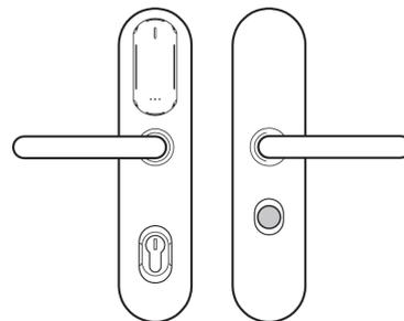
EM6P6 (beidseitig Drücker, mechanische Notöffnung mit elektronischer Protokollierung über Halbzylinder außen, mechanischer Zylinder nicht enthalten, elektronische „Bitte nicht stören“-Funktion innen)
